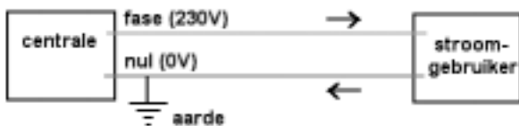
figuur 1: de stroomsterktes in de fase- en nulleidingen zijn tegenovergesteld en precies gelijk. De neutraliteit van de nulleiding wordt 'vastgeklemd' doordat zij in verbinding met de aarde wordt gebracht.
