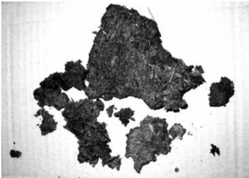
Spaanplaat, verrot na elf jaar inwateren (IE)
