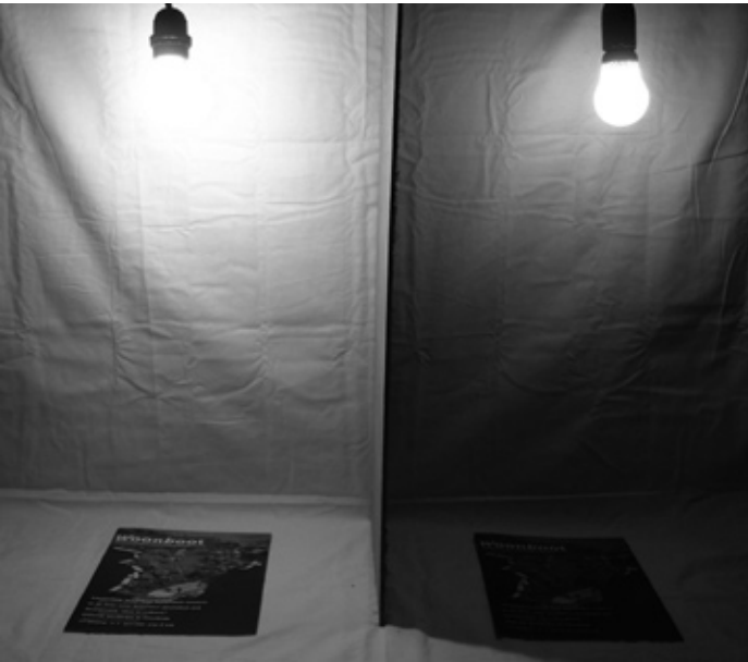
Hier de testopstelling met links de 25W gloeilamp en rechts de “1,2W” led-lamp. Met beide lampen in dezelfde foto kan er geen vertekening van de resultaten optreden door automatisen van het fototoestel. De achtergrond is een wit katoenen laken. De led-lamp is blauwig en overduidelijk zwakker.
