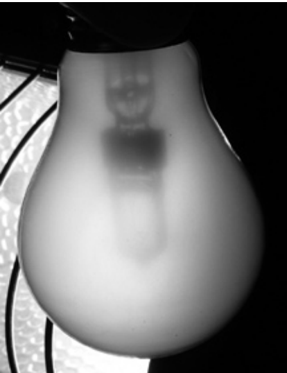
“Röntgen”foto van de 30% turbolamp; opvallend is dat het glas een rode tint heeft om het blauw-witte licht van het halogeenlampje iets warmer te maken. De lichtbron voor deze foto is een goudeerlijke, maar beslist niet “groene” halogeenstraler van 500W.
