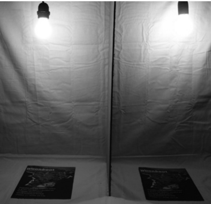
Links een gloeilamp van 40W en rechts de “turbo”-lamp van “28W”. De rode tint in het glas dempt het felle wit, maar de kleur is toch witter dan die van de gloeilamp en ondanks 10% gesmokkeld vermogen is de lichtopbrengst een vleugje minder.
