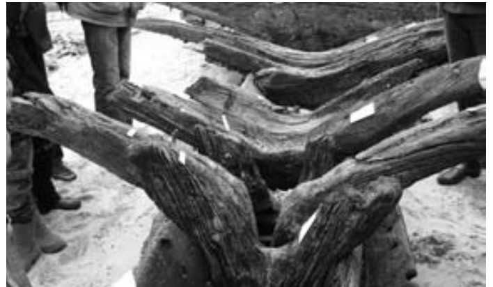
Vermoedelijk was geïmporteerd hardhout in die tijd duur en uiteraard geen serieproduct. Een scheepsbouwer moest het doen met wat hij voorhanden had. Hier zien we hoe ribben met de juiste buiging werden gemaakt, de ene keer uit een vork en de andere keer uit een gebogen tak.
