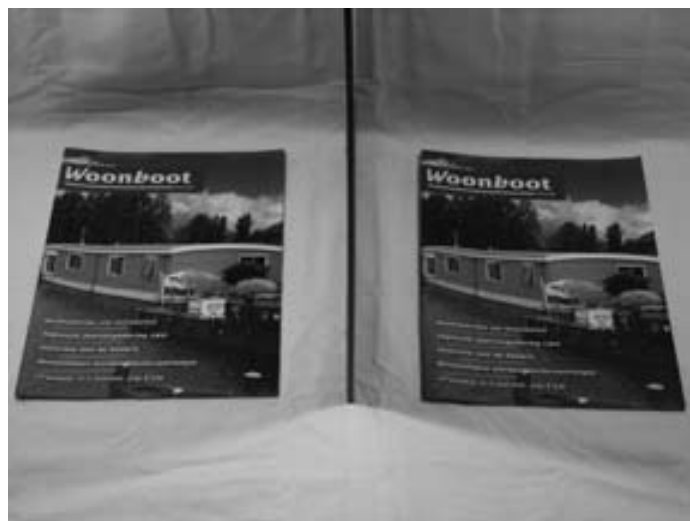
De verlichting op twee identieke voorwerpen van dichtbij gezien. De lichtsterkte onder de beide lampen is nagenoeg gelijk maar in de kleurweergave is een klein verschil zichtbaar. Het effect is voor veel mensen acceptabel, maar voor andere niet te pruimen.
