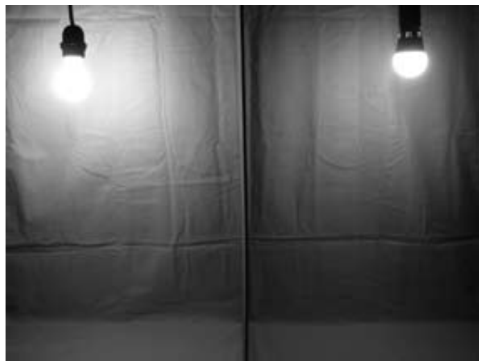
Hier de Pharox 300 naast een gloeilamp van 60W. De Pharox-lamp lijkt stukken minder fel, maar dat komt omdat de lichtafgave verspreid is over de hele oppervlakte van het glas.
